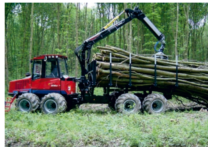
Figuur 8. Lokale biomassa-extractie uit jong bos met behulp van een bosbouw-forwarder (foto: Borgman Beheer Advies B.V.)
