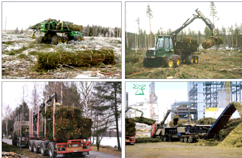
Figuur 4.3 – Foto's: Een Pinox bundelmachine op een kaalkapvlakte. De bundels worden met een forwarder opgehaald en op een houtvrachtwagen geladen. Bij de centrale worden de bundels versnipperd door een zware, stationaire versnipperaar (Lechner, 2004).
