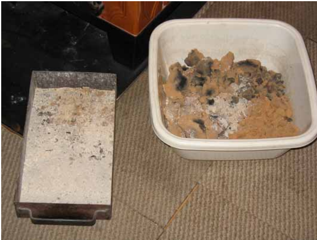
Asresten na verbranding van hoogveenturf (links) en rietplaggenturf (rechts) in een speksteenkachel (Foto dhr. Han Visser)
