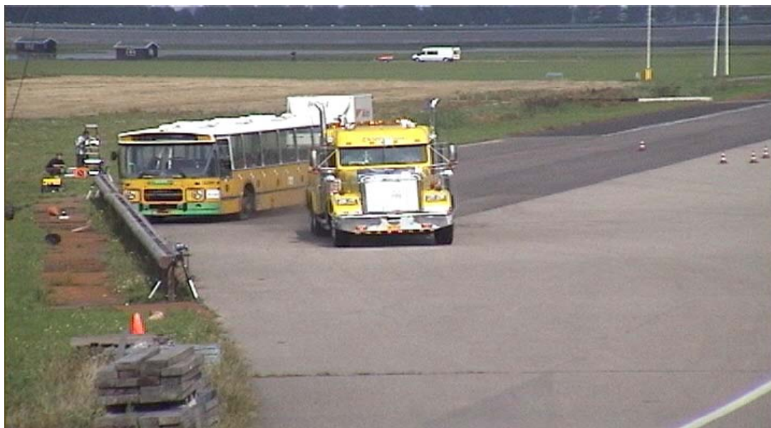
Botstest houten geleiderail conform de Europese normen
