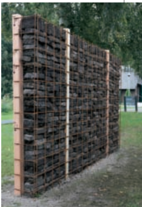
Rietplagsel isoleert geluid stukken beter dan hout.
