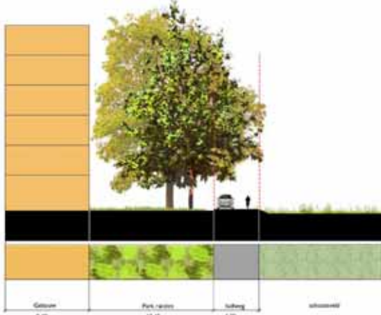
Doorsnede van de route langs de parkrand, op de overgang naar het shootsveld, met auto en lv gemengd (li.) en alleen langzaam verkeer (re.)
