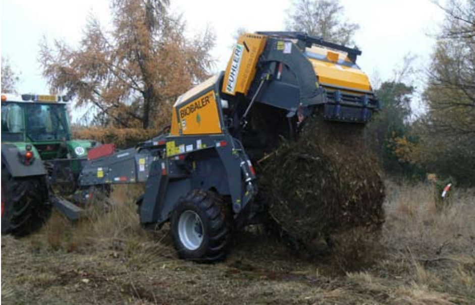
De balen die de Biobaler produceert wegen tot 600 kilogram, hetgeen overeenkomt met ongeveer 1,2 MW/uur. (foto Probos)
