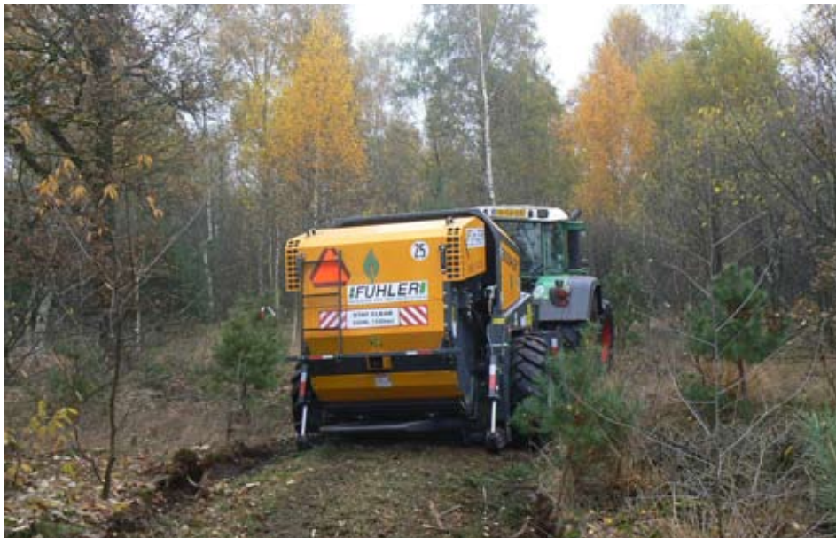
Het grote voordeel van de Biobaler is dat in één werkgang en met één machine houtige vegetatie kan worden verwijderd en er een goed transporteerbare en droogbare biomassa ontstaat. (foto Probos)
